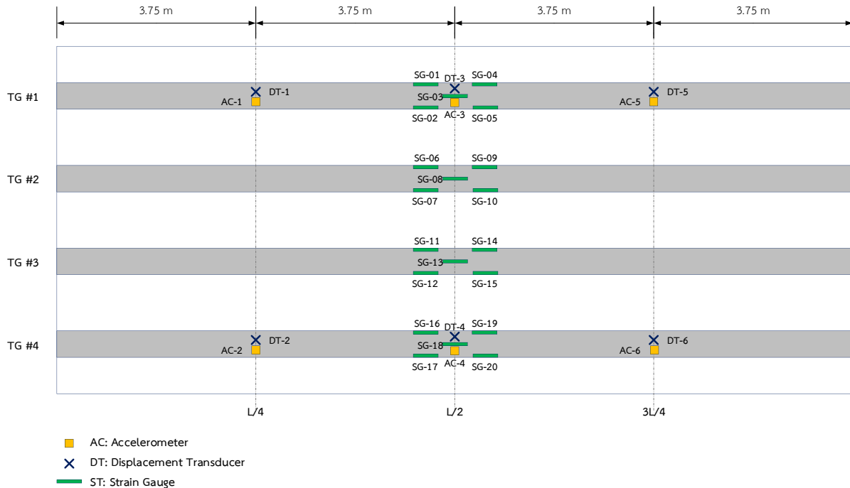
รูปที่ 8-13 ตำแหน่งติดตั้งอุปกรณ์ตรวจวัด
