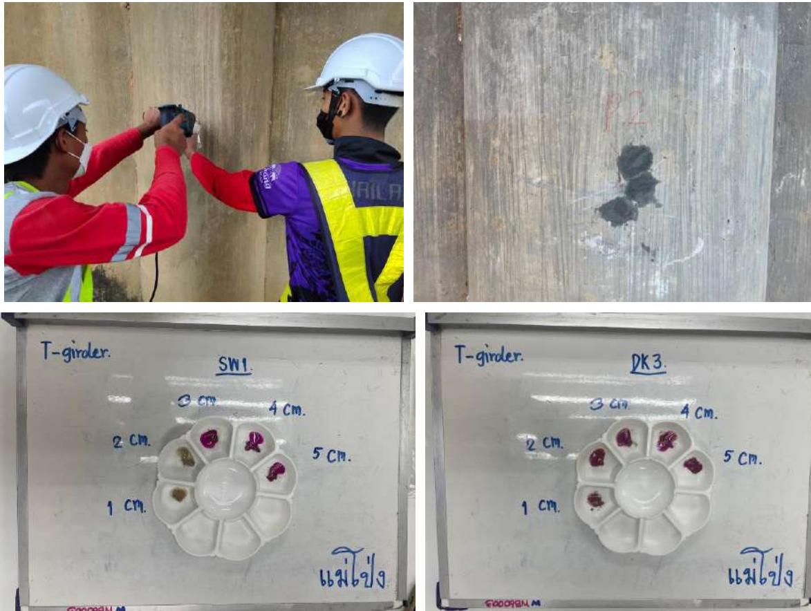
รูปที่ 7-12 รูปการทำงานทดสอบการเกิดคาร์บอนเนชัน
