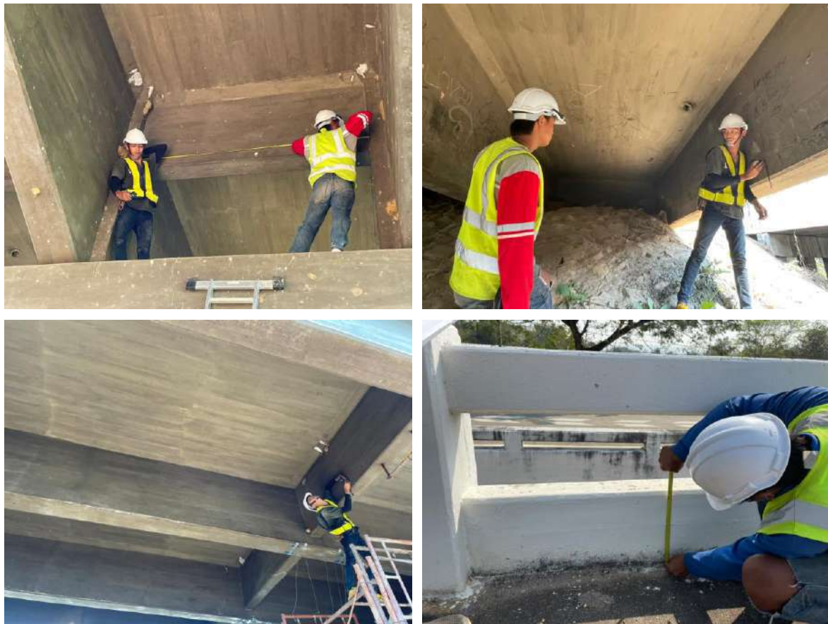
รูปที่ 7-2 การตรวจวัดมิติของสะพาน (ทั่วไป)
