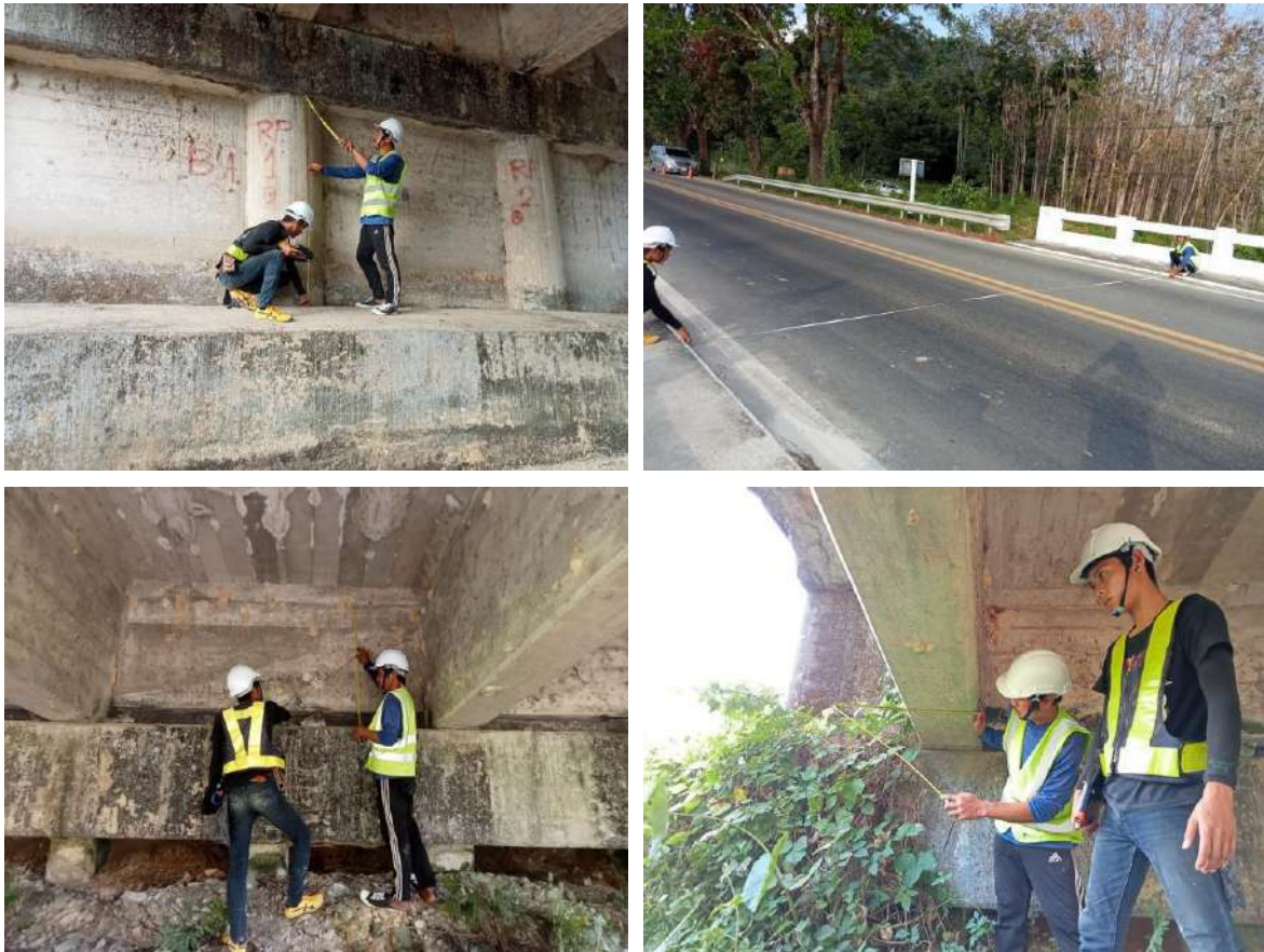
รูปที่ 8-2 การตรวจวัดมิติของสะพาน (ทั่วไป)
