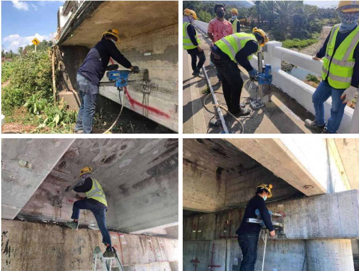
รูปที่ 8-8 รูปการทำงานเก็บวัสดุทดสอบกำลังคอนกรีต
