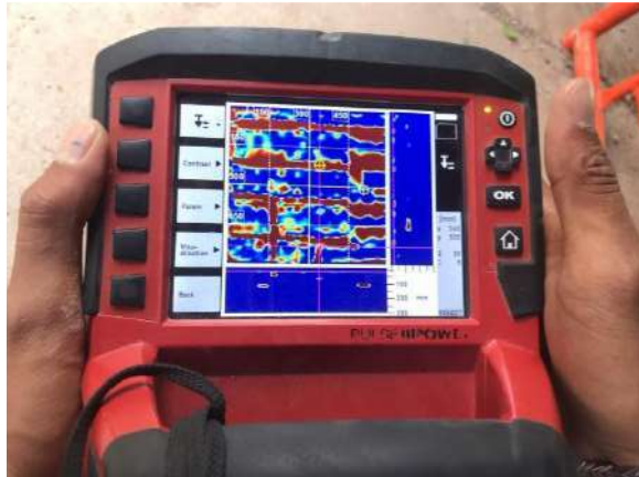
รูปที่ 9-6 รูปการสำรวจรายละเอียดเหล็กเสริมโครงสร้างสะพานด้วยเครื่อง GPR
