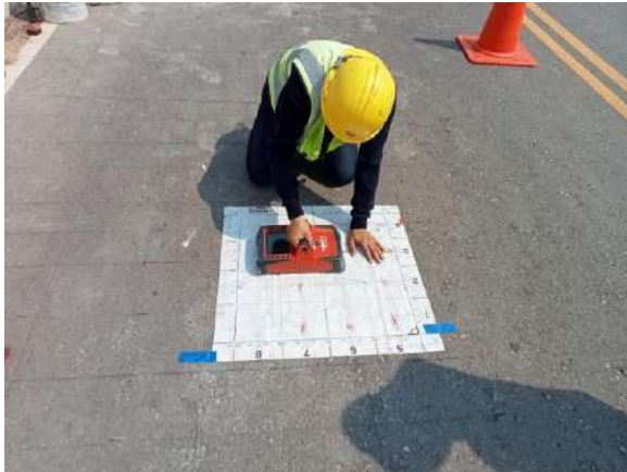
รูปที่ 7-6 รูปการสำรวจรายละเอียดเหล็กเสริมโครงสร้างสะพานด้วยเครื่อง GPR
