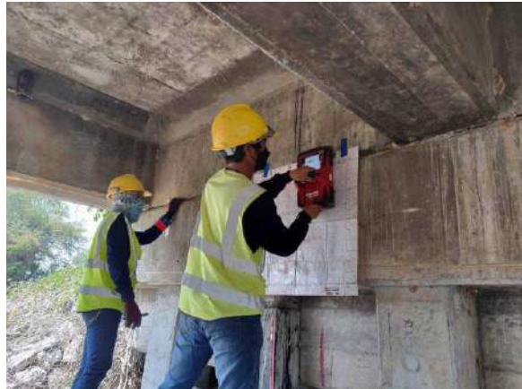
รูปที่ 7-6 รูปการสำรวจรายละเอียดเหล็กเสริมโครงสร้างสะพานด้วยเครื่อง GPR
