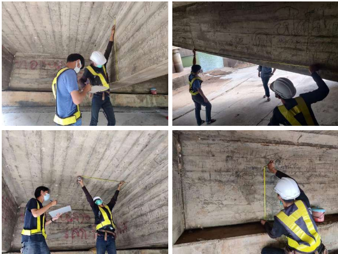
รูปที่ 9-2 การตรวจวัดมิติของสะพาน (ทั่วไป)
