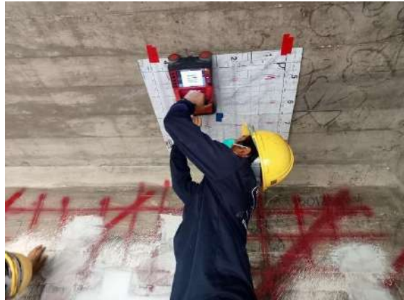
รูปที่ 9-6 รูปการสำรวจรายละเอียดเหล็กเสริมโครงสร้างสะพานด้วยเครื่อง GPR
